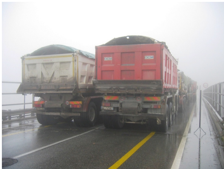
Prova di carico
