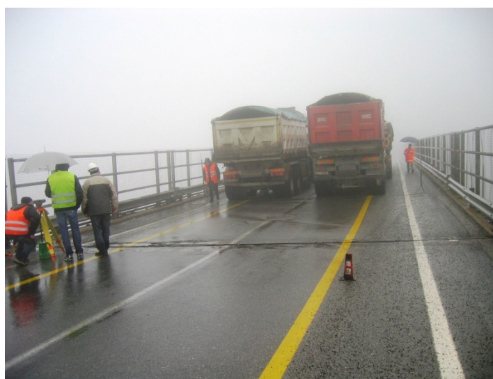
Prova di carico
